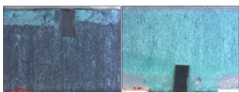
Figura 9 Superficie di frattura dei provini con difetto
