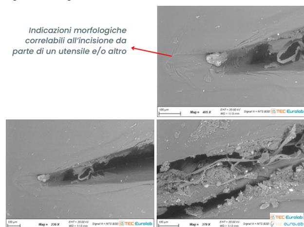
Per quanto concerne la superficie di frattura, essa è caratterizzata da una **morfologia duttile**, deformata plasticamente e con dei segni correlabili ad un fenomeno di abrasione del materiale.
