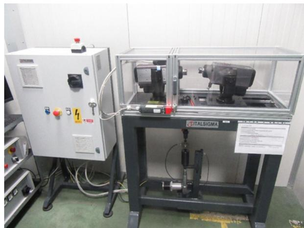
Figura 12.a - Macchina a flessione rotante
