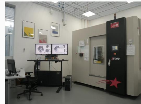
Analisi tomografica per verificare lo stato di integrità del componente
