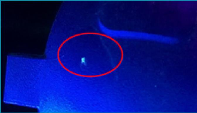
Identificazione di indicazioni lineari o non lineari in superficie - analisi PT
