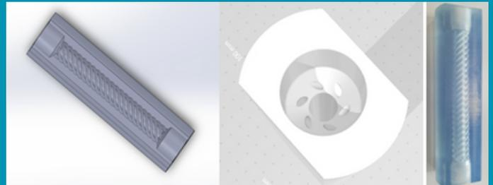
Ottenimento modelli CAD di componenti finiti - reverse engineering mediante analisi tomografica
