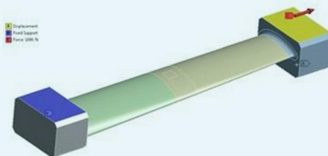
Fig. 6 Impostazione modello FEM in Ansys Workbench
