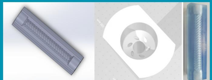
Ottenimento modelli CAD di componenti finiti - reverse engineering mediante analisi tomografica
