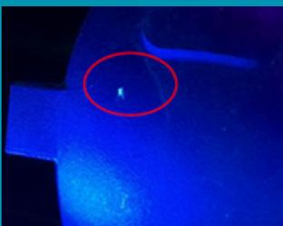
Identificazione di indicazioni lineari o non lineari in superficie - analisi PT
